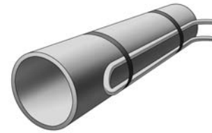
FIG. R - Placés latéralement contre des murs, trémies ou tuyaux
